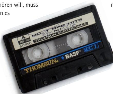
wieder in gleicher Geschwindigkeit am Tonkopf vorbeilaufen lassen. Dann wird der Aufnahmevorgang rückwärts durchlaufen. Das heißt, die magnetischen Partikel auf dem Band kommen am Tonkopf vorbei und induzieren in der Spule einen Strom (so ähnlich wie im Mikrofon – siehe Seite 13-14). Daraus entsteht ein elektrisches Signal, welches vom Lautsprecher wieder in Schall verwandelt werden kann.
